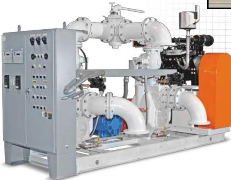
Станція Gorman-Rupp з автоматичним запуском на рамі використовує контроль рівня рідини, який автоматично перетворює сигнали поплавків на 12 В постійного струму і запускає насос від резервного двигуна внутрішнього згоряння, щоб забезпечити нормальній режим роботи насосу при збоях електричного живлення.
